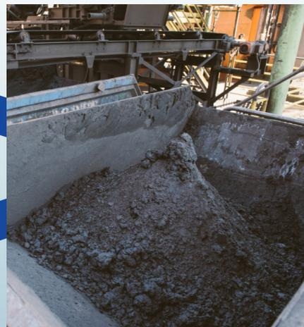
➤ Todos os meses, são gerados três mil toneladas de lama de Alto-Forno no processo de desidratação através do filtro-prensa
